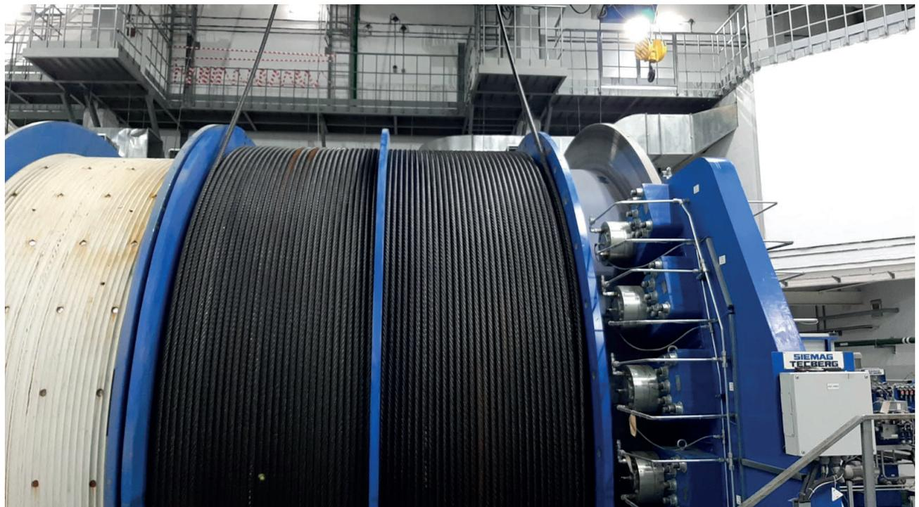
Bild 6: In der vierten Lage aufgespulte Oberseile auf der Doppeltrommel-Blair Fördermaschine.
