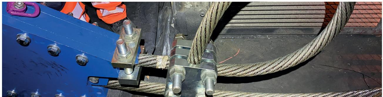
Bild 7: In einer Klemmkausche eingebundenes Förderseil. Bei Klemmkauschen zieht sich das Seil durch seine Belastung und dem Reibschluss am Keilverschluss selbsttätig fest.
