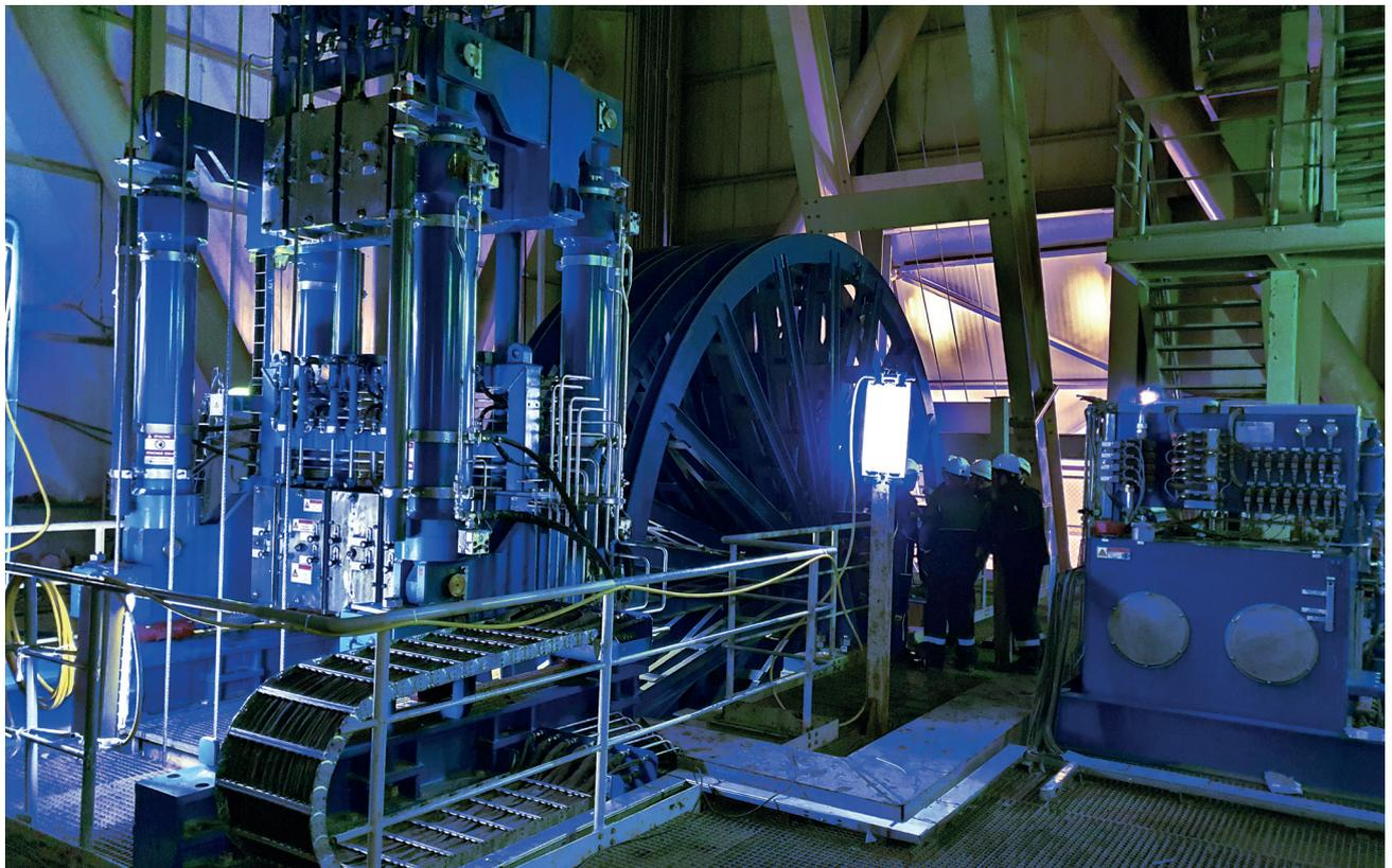
Bild 3: Klemm- und Hubeinrichtung zur Handhabung von Förderseilen in einem Arbeitsgang.
