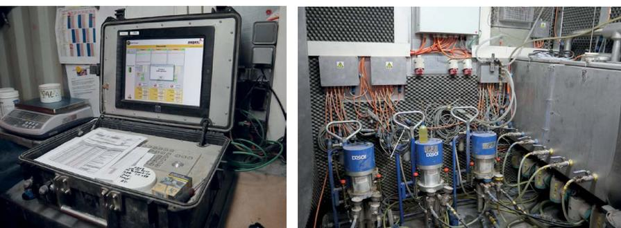
**Bild 7:** Mess- und Regeltechnik für Acrylatgelinjektion beim Tunnel Feuerbach
