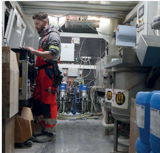
**Bild 8:** Injektionsanlage für Acrylatgel und Einfüllvorgang der Einzelgebände
